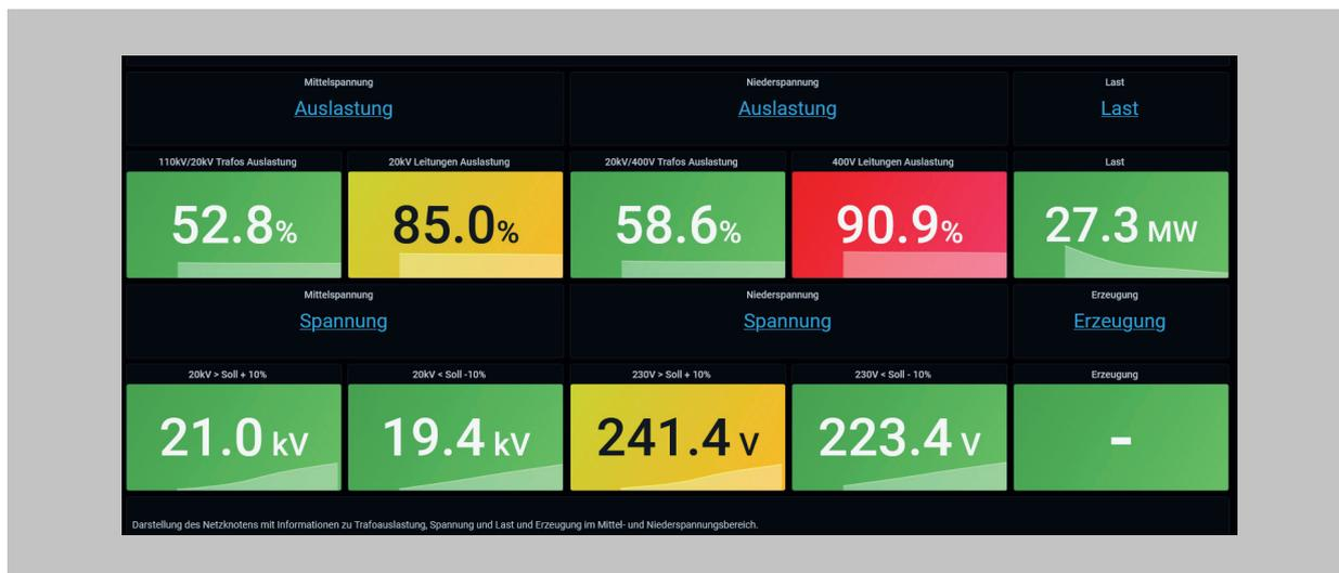
Der ständig steigende Anteil volatiler Energiemengen aus Einspeiseanlagen bringt zu Spitzenzeiten eine hohe Last auf Transformatoren in Ortsnetzstationen. Diese lassen sich u. a. in der Erwärmung der verbauten Komponenten messen. Die Installation von IoT-fähigen Temperaturfühlern an betroffenen Anlagen kann frühzeitig einen Engpass aufzeigen, der es einem Netzleitsystem ermöglicht gegenzusteuern, bevor es zu einem plötzlichen Ausfall kommt.
