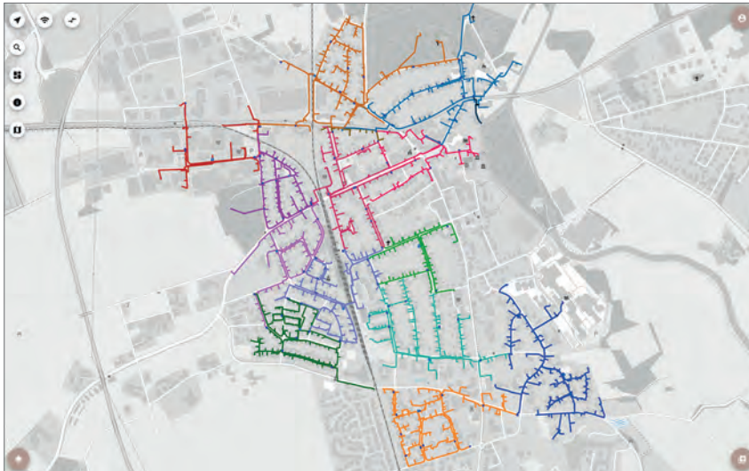
Bild 4. Transparenz und Übersicht im Niederspannungsnetz mit der Smart Grid Operation Plattform
