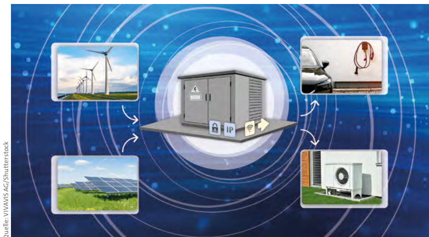
Die intelligente Ortsnetzstation als Bindeglied zwischen Energieerzeugung und -verbrauch
