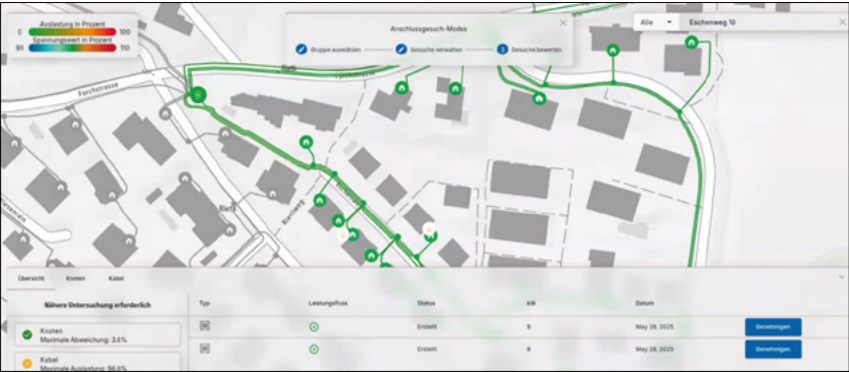
Abbildung 5. Netzanschlussbegehren präzise prüfen dank Kabel- und knotenscharfer Lastflussberechnung
